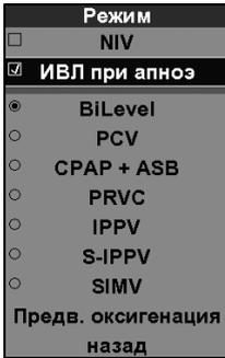
Режим ИВЛ, к которому обращается аппарат для ИВЛ при апноэ, отмечен в меню «Режим». Первоначально выбранный режим ИВЛ и пункт меню «ИВЛ при апноэ» отмечены красным цветом.
