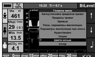
Чтобы обеспечить оптимальное считывание данных с дисплея и при работе в ночное время, можно активировать режим дисплея «Цвета ночью». В этом режиме индикация осуществляется на черном фоне, чтобы не ослеплял свет дисплея. Яркость цветов ночью задается в меню «Аудио/видео» (см. «7.6 Аудио / видео» на странице 86).
