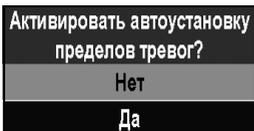
Если активирована функция «Автоустановка пределов тревог», аппарат автоматически задает пределы для сигналов, связанных с физиологией дыхания. Определяющими для задания пределов являются измеренные в момент активации значения параметров ИВЛ ( $V_{t_e}$ ,  $MV_{e_e}$ ,  $f$ , при необходимости  $etCO_2$ ).
